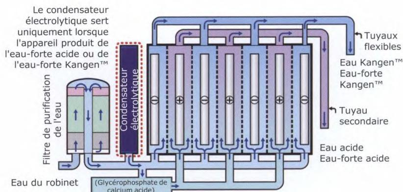
Si vous pressez le bouton « Eau forte acide », le tuyau secondaire délivre de l'eau forte acide tandis que le tuyau flexible délivre simultanément de l'eau forte Kangen™.
